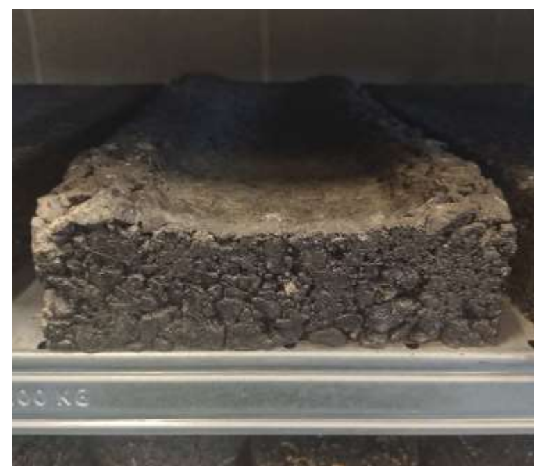
CARPETA ASFÁLTICA FUERA DE NORMA SB250 v.4.1 (SIN ACONDICIONADOR)
